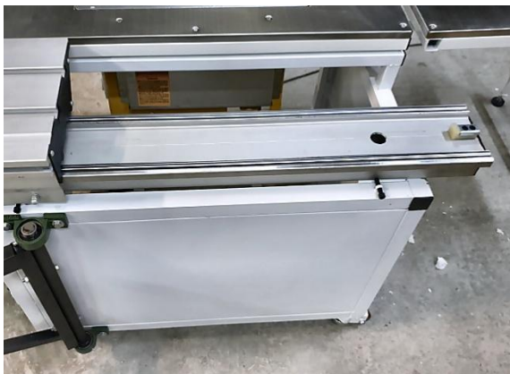
МЕХАНИЗМ ПОДВИЖНОЙ КАРЕТКИ С НАПРАВЛЯЮЩИМИ И ПОДШИПНИКАМИ
