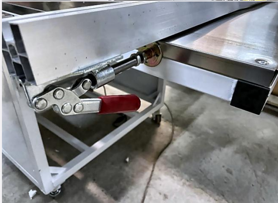
КРЕПЛЕНИЕ ЛИНЕЙКИ ПАРАЛЛЕЛЬНОГО УПОРА С ПОМОЩЬЮ БЫСТРО-ЗАЖИМНОЙ РУЧКИ
