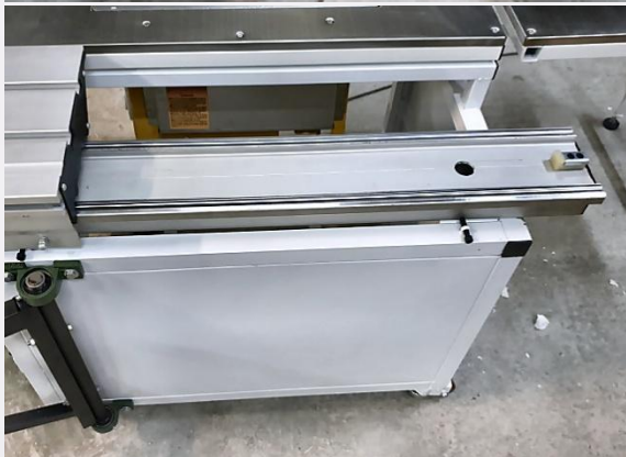
МЕХАНИЗМ ПОДВИЖНОЙ КАРЕТКИ С НАПРАВЛЯЮЩИМИ И ПОДШИПНИКАМИ
