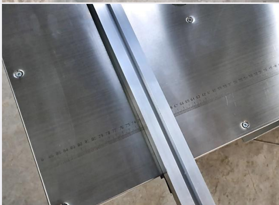
НАНЕСЕННАЯ ПУТЕМ ГРАВИРОВКИ МИЛЛИМЕТРОВАЯ ШКАЛА ЛИНЕЙКИ ПАРАЛЛЕЛЬНОГО УПОРА
